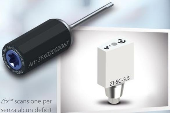
I due pezzi corpi Zfx™ scansione per utilizzo multiplo senza alcun deficit di accuratezza vengono prodotte con sistema di codice innovativo, che consente il riconoscimento automatico del tipo di impianto e previene errori di applicazione. Così, in combinazione con la chiave dinamometrica sviluppata per il Zfx™ Evolution plus, una precisione è assicurata di  $< 5 \mu\text{m}$
