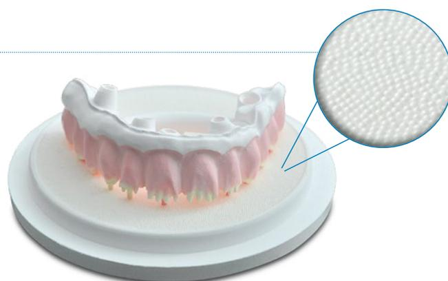
Perle di sinterizzazione Zfx™ (30 – 60 micron) per un processo di sinterizzazione precisa
